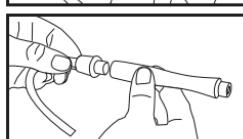
4. Spojite kraj cijevi na ručni uređaj.
