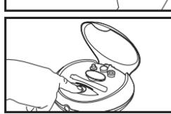
6. Sada pritisnite **prekidač** za uključivanje uređaja. Prikaz razine intenziteta počinje svijetliti. Sada ste na najnižoj razini intenziteta.
